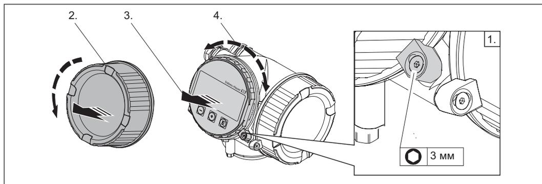
1. Ослабьте зажим крышки отсека электронной вставки с помощью шестигранного ключа.
