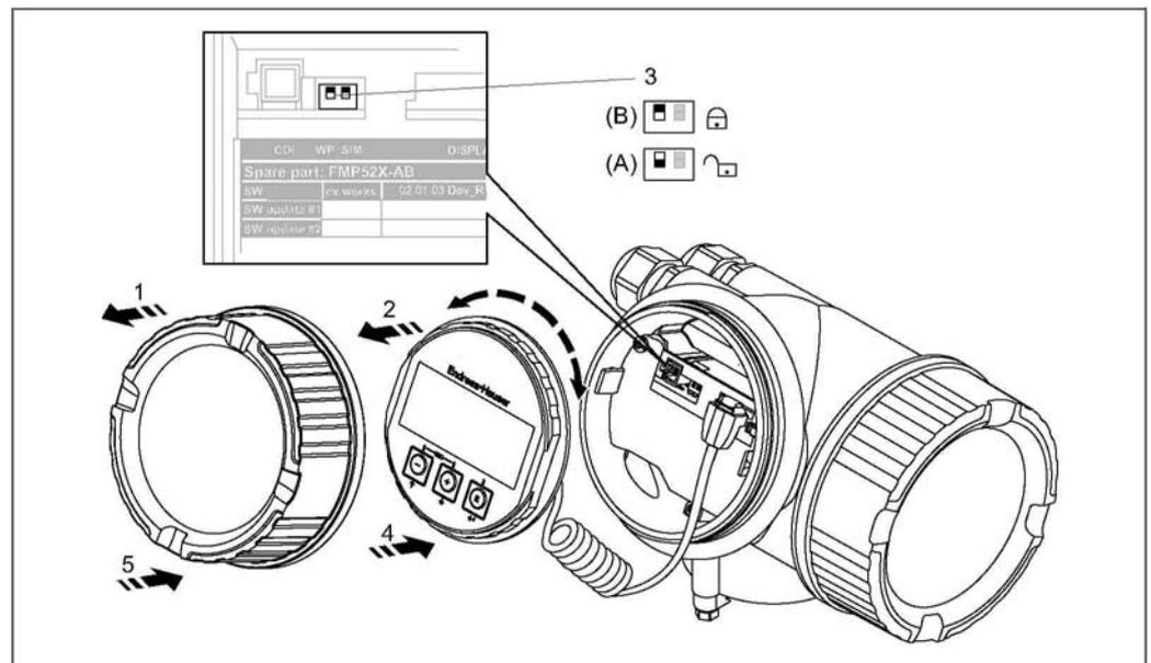
1. Скрутите крышку отсека модуля дисплея и управления.
