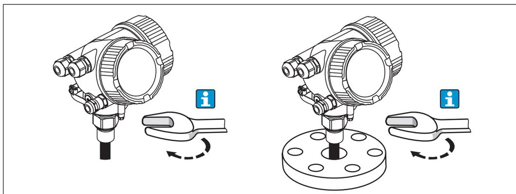
Приборы с крепежной резьбой ввинчиваются в приварную бобышку или фланец, которыми они и крепятся.
