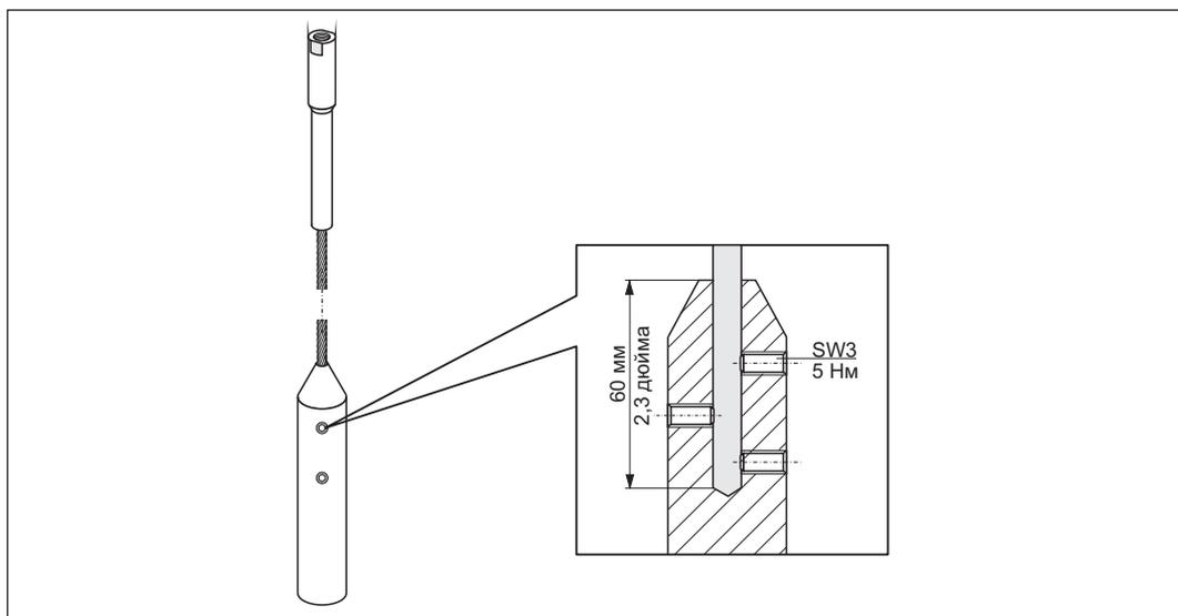
1. Ослабьте 3 шестигранных установочных винта с помощью шестигранного ключа AF3. Примечание. На винты нанесен Loctite. Сначала может потребоваться размягчить их термофеном.
