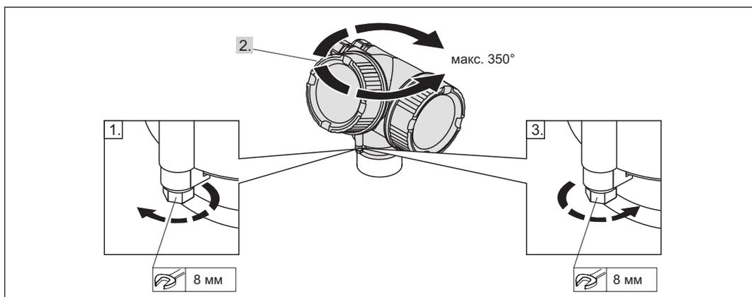
1. Отвинтите крепежный винт с помощью рожкового гаечного ключа.
