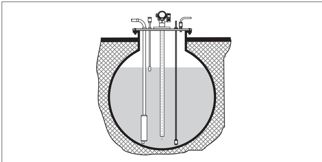
В случае установки в патрубок с большим диаметром рекомендуется использовать коаксиальный зонд во избежание отражения сигнала от стенки патрубка.
