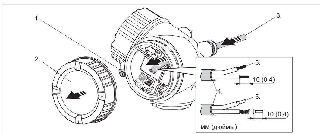
1. Освободите зажим крышки клеммного отсека.
