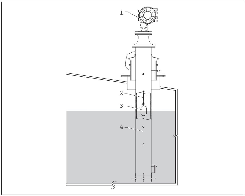
■ 3 Типовой монтаж в резервуаре 1
