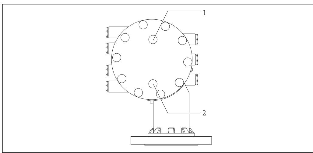
■ 23 Отверстия для очистительного патрубка и патрубка для продувки газом
