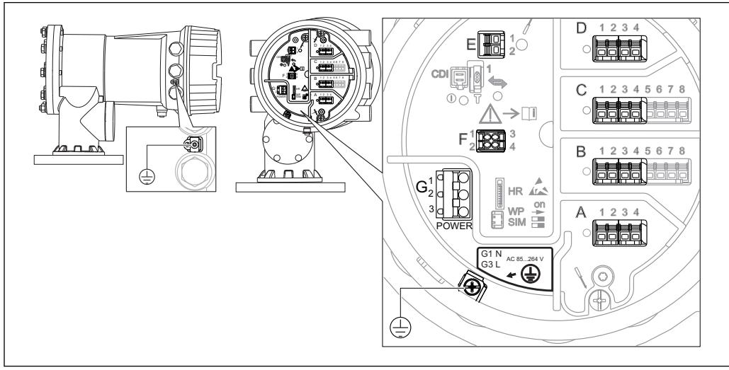
■ 11 Клеммный блок (типичный пример) и клеммы заземления
