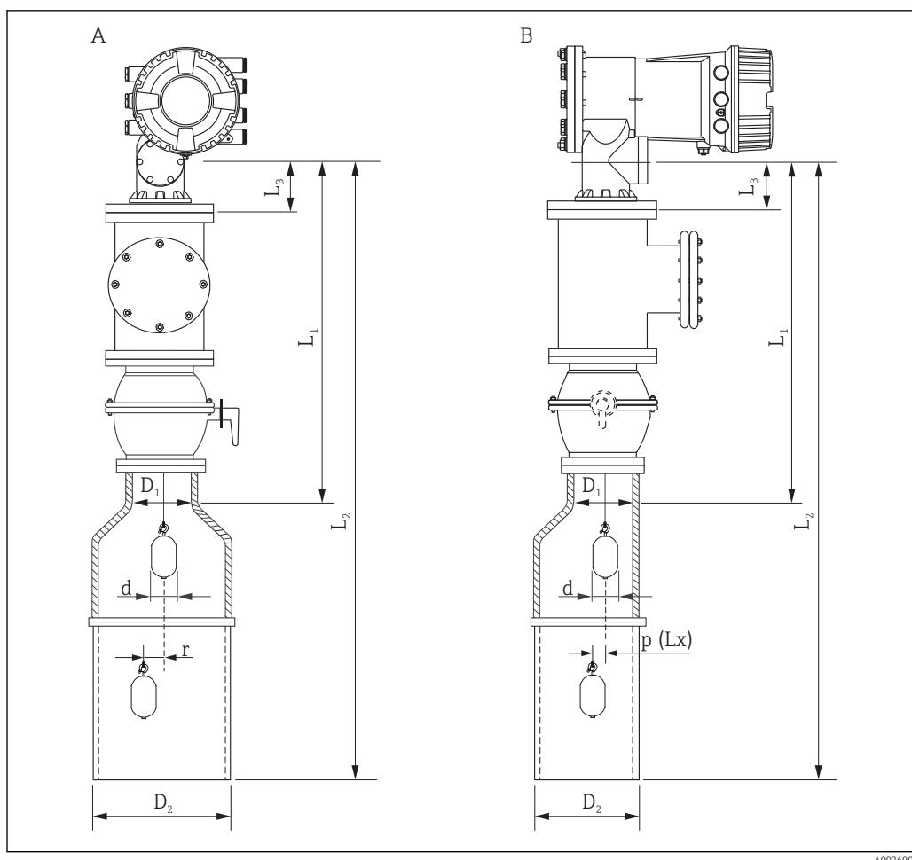
■ 13 Монтаж с асимметричной успокоительной трубой
