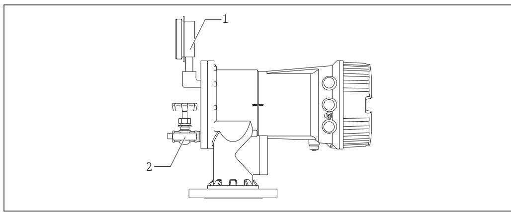
■ 22 Монтажная позиция перепускного клапана и датчика давления
