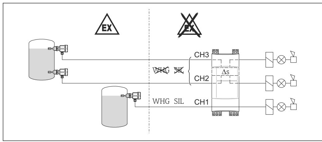
4. Канал CH2 используется для измерения предельного уровня с помощью двух реле уровня, а канал CH1 применяется для дополнительного измерения предельного уровня
