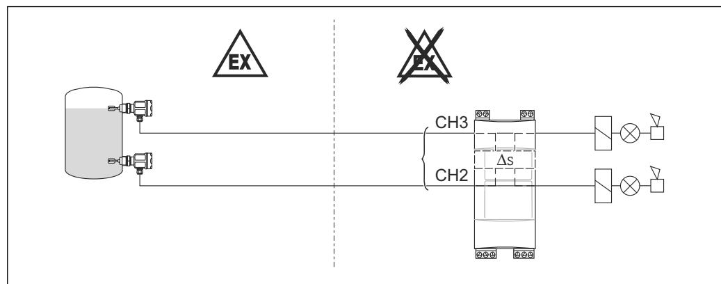
3. Каналы CH2 и CH3 используются для контроля по двум точкам  $\Delta s$ , а канал CH1 для защиты от перелива
