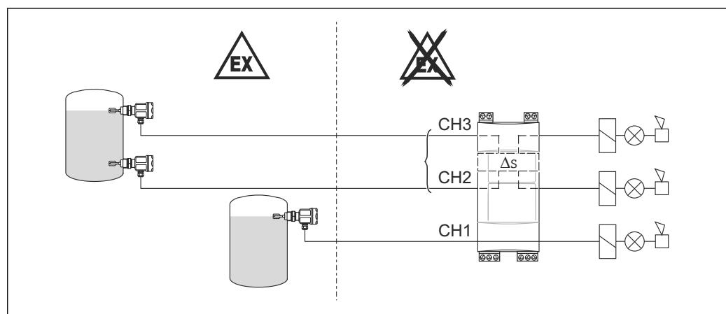
4. Канал CH2 используется для измерения предельного уровня с помощью двух реле уровня, а канал CH1 применяется для дополнительного измерения предельного уровня
