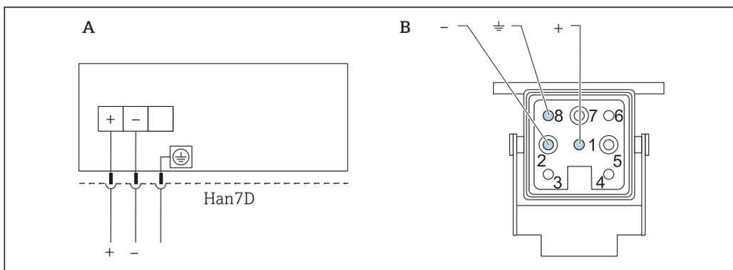
A Электрическое подключение приборов с разъемом Harting Han7D
