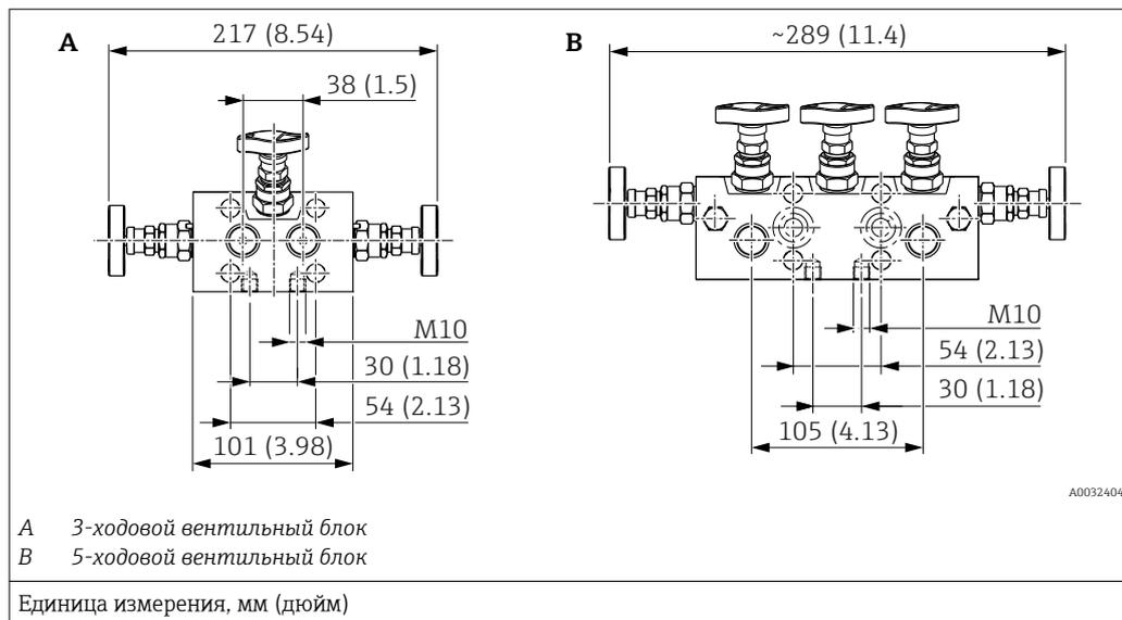
3- или 5-ходовой вентильный блок из стали 316L или сплава AlloyC можно:
