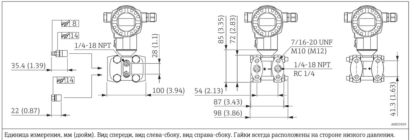
Единица измерения, мм (дюйм). Вид спереди, вид слева-сбоку, вид справа-сбоку. Гайки всегда расположены на стороне низкого давления.
