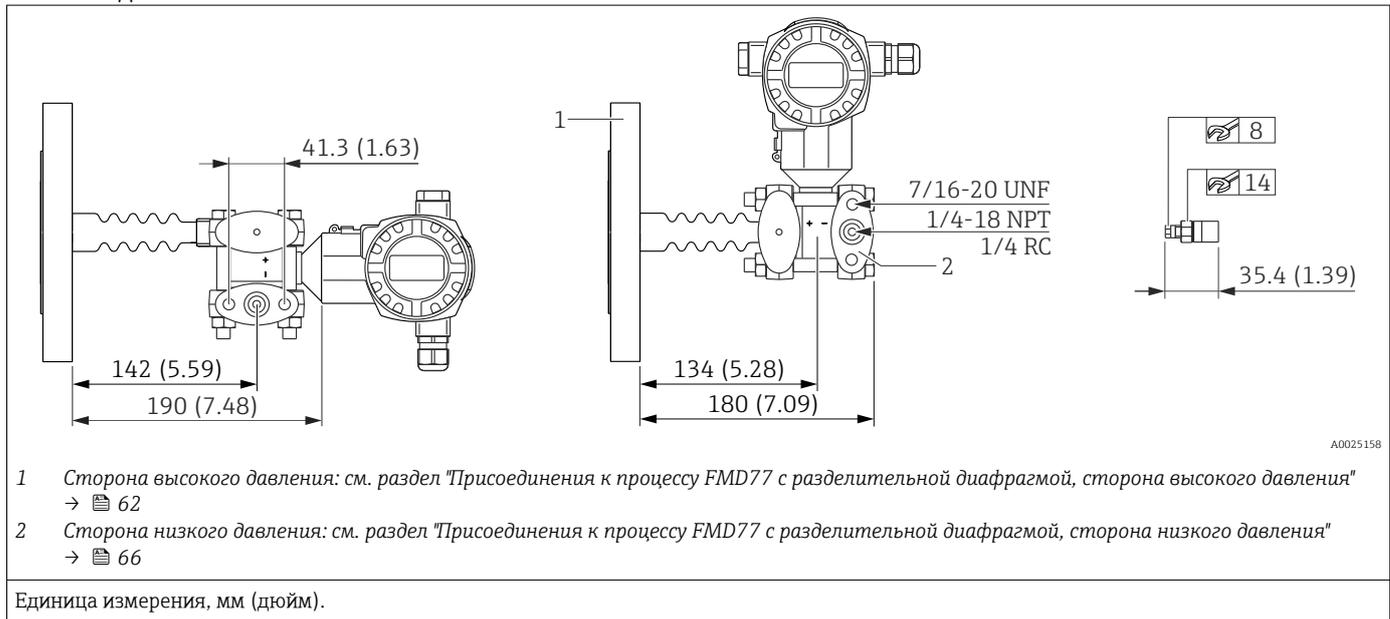
**Прибор с коротким теплоизолятором**
