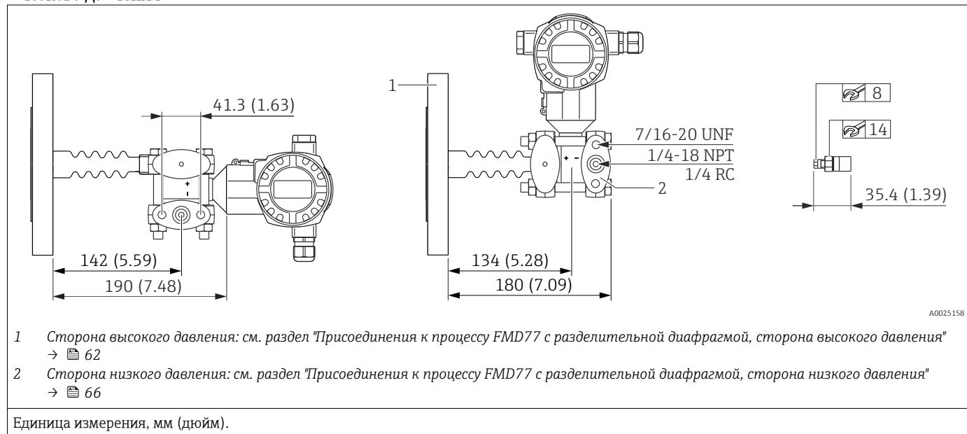
Прибор с коротким теплоизолятором
