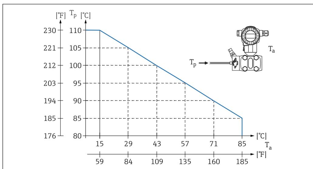
$T_a$  Максимальная температура окружающей среды на вентильном блоке
