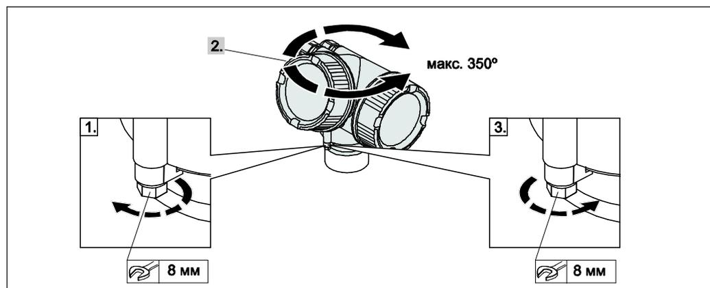
1. Отвинтите крепежный винт с помощью рожкового гаечного ключа.
