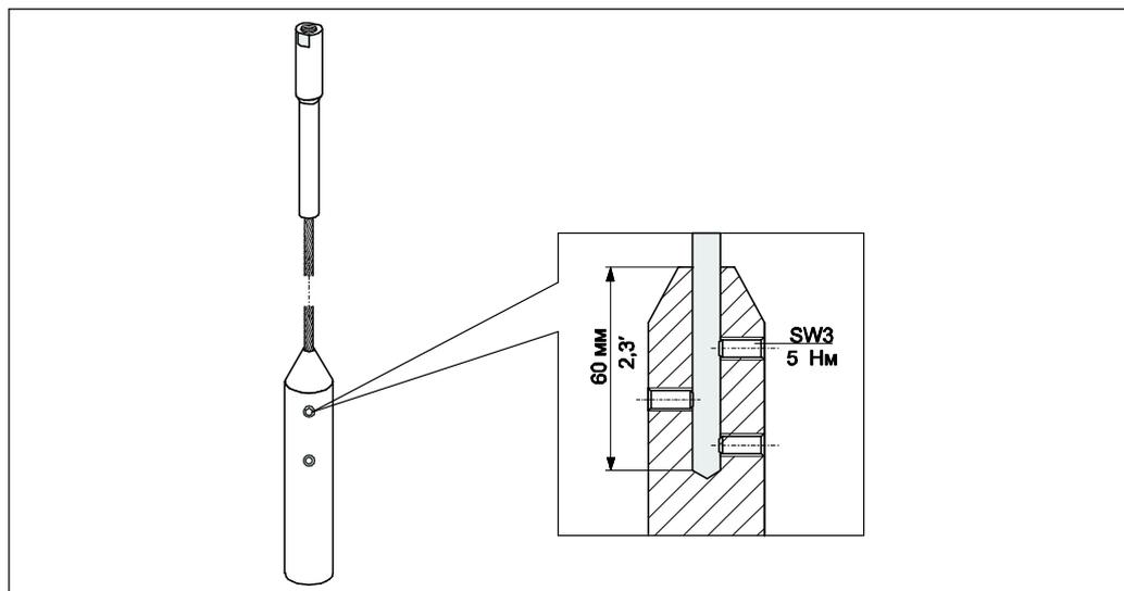
1. Ослабьте 3 шестигранных установочных винта с помощью шестигранного ключа AF3. Примечание. На винты нанесен герметик Loctite. В некоторых случаях может потребоваться размягчение герметика с помощью термофена.
