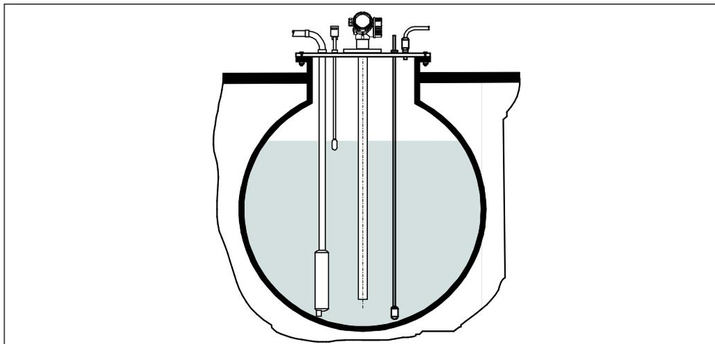
При установке в патрубке с большим диаметром рекомендуется использовать коаксиальный зонд во избежание отражения сигнала от стенки патрубка.
