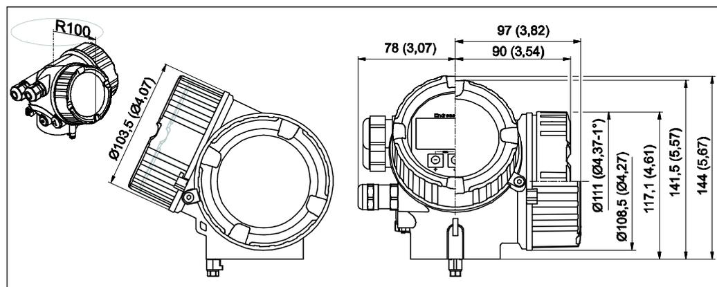
6 Корпус GT20 (алюминий с покрытием); размеры в мм (дюймах)
