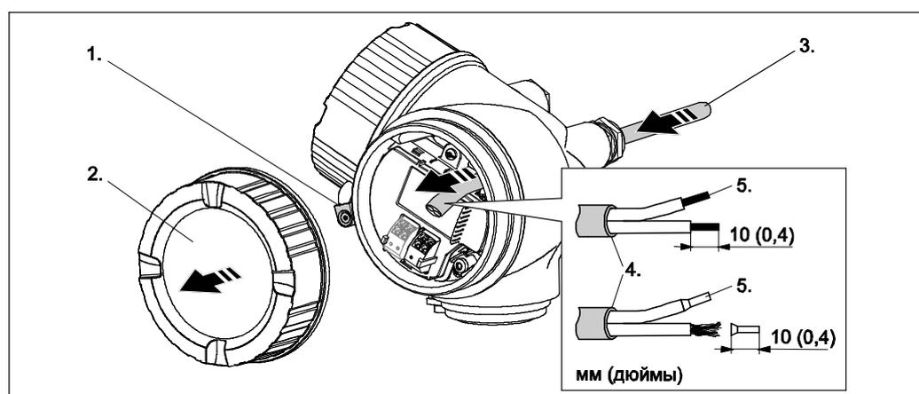
1. Освободите зажим крышки клеммного отсека.
