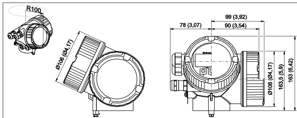
5 Корпус GT19 (пластмасса ПБТ); размеры в мм (дюймах)
