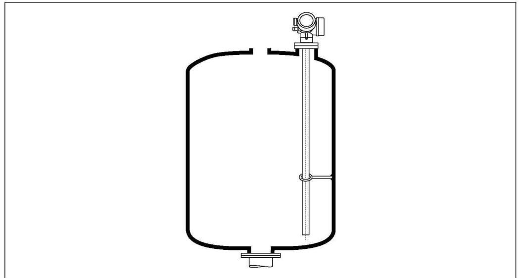
Коаксиальные зонды могут быть зафиксированы в любой точке по всей длине внешней трубки.
