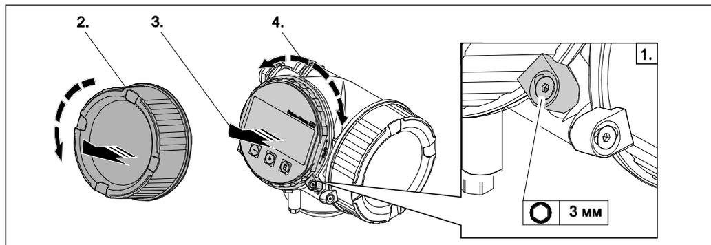
1. Ослабьте зажим крышки отсека электронной вставки с помощью шестигранного ключа.
