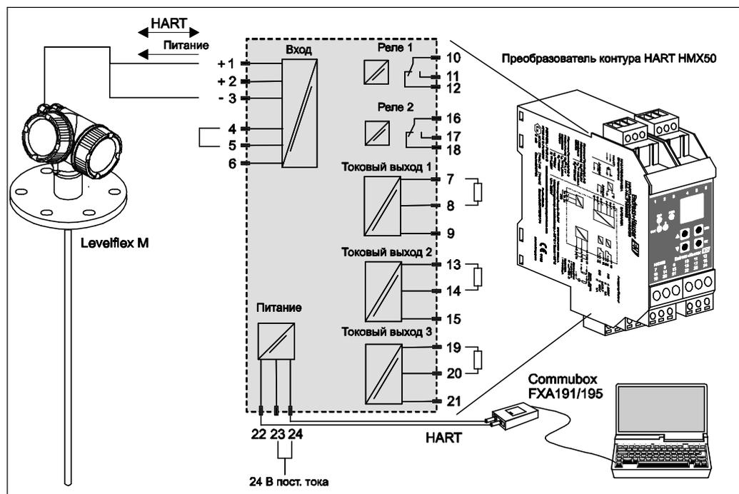
7 Схема подключения преобразователя контура HART HMX50 (пример: пассивный 2-проводный прибор и токовые выходы, подключенные как источник питания)
