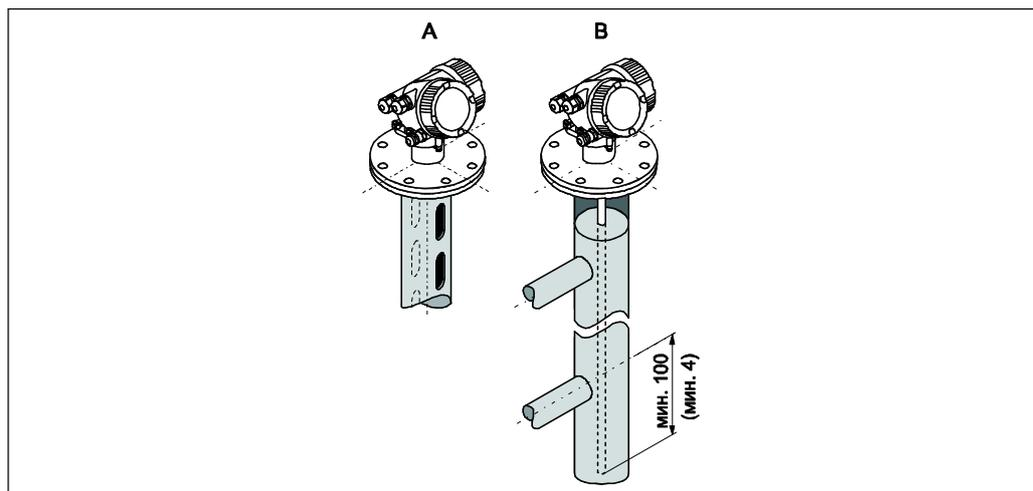
A Монтаж в измерительной трубе
