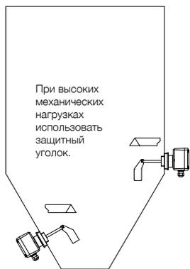
Исполнение с удлинением предназначено только для сигнализации верхнего предельного уровня
